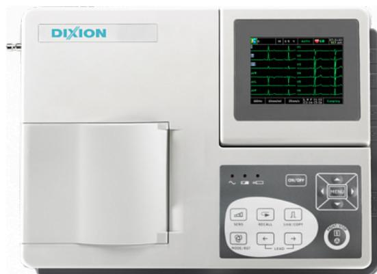
Современный дизайн, элегантный внешний вид. Простое и удобное управление с пленочной клавиатуры. Большой цветной ЖК дисплей. Сохранение до 500 ЭКГ в памяти электрокардиографа. Цифровое управление, цифровая фильтрация, автоматический контроль базовой линии. Работа с меню на ЖК-дисплее. Автоматическая интерпретация измерений. Встроенный аккумулятор, автоматическое переключение источника питания. Встроенный термопринтер.
