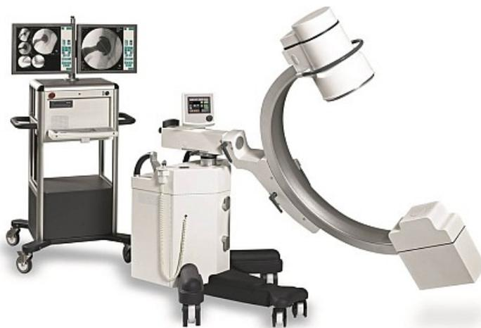
Хирургический рентген-аппарат Dixon Cyberbloc — одно из лучших решений в классе систем типа С-дуга. Он предназначен для визуального контроля при проведении хирургических вмешательств. Система совмещает минимальную дозу облучения пациента и высокую точность отображения сосудов, твердых и мягких тканей.
